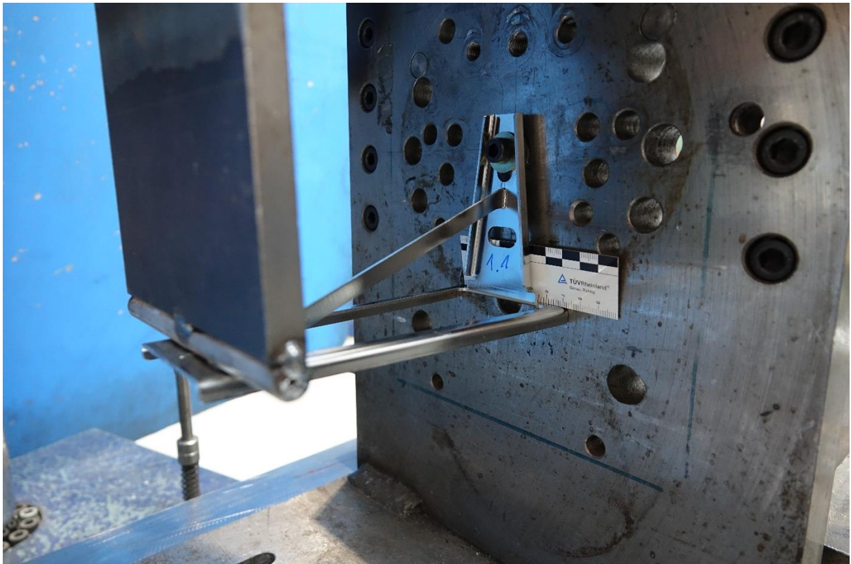
Bild 1. Winkel 1.1 vor Belastung in der Prüfmaschine.
