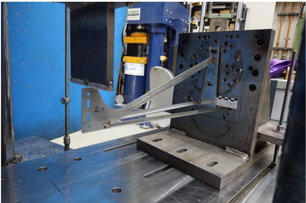
Bild 4. Winkel 2.1 vor Belastung in der Prüfmaschine.
